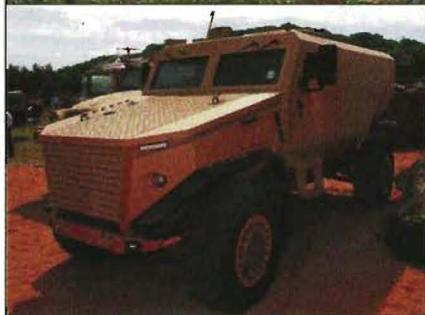
взрывном устройстве. Высокая степень унификации машины дает возможность размещать на платформе различное специальное оборудование и быстро заменять его в полевых условиях. «Оцелот» может оснащаться системами централизованной подкачки шин, кондиционирования воздуха, аппаратурой связи, радиоэлектронного подавления радиоуправляемых взрывных устройств и др. Машина будет использоваться прежде всего в «горячих точках».
