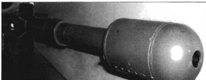
*Разведывательная граната Refaim, выполненная на базе винтовочной гранаты для MPRS*
