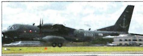
В мае 2010 года ВМС Чили получили самолет базовой патрульной авиации C-295MPA. В общей сложности они должны получить еще два патрульных и такое же количество противолодочных самолетов C-295, которые в техническом оснащении очень близки друг к другу. Основным отличием C-295ASW от C-295MPA является возможность запуска самолетом двух торпед с подкрыльевых пилонов.
