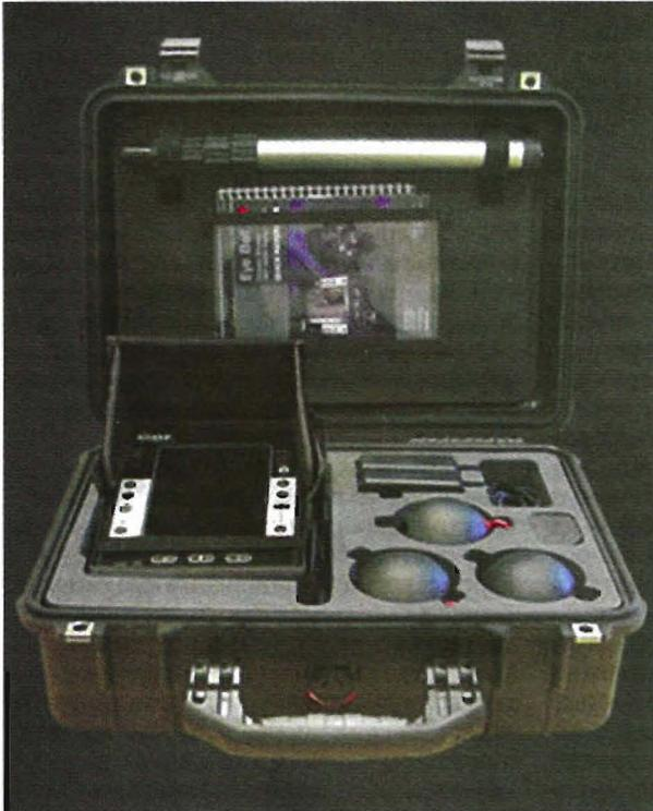
**Шарообразные датчики системы Eye Ball R1 и укладка полевого варианта комплекта Eye Ball R1 в кейсе**
