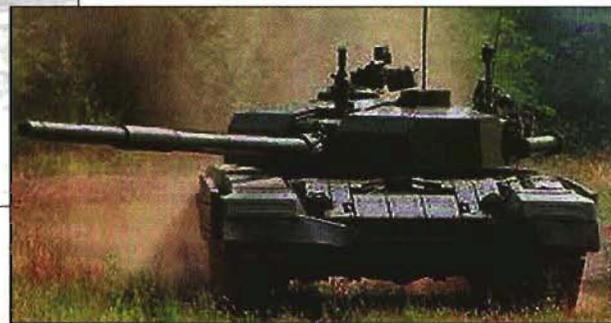
ный дальномер, дневные и ночные прицелы, тепловизионные приборы. Командир и механик-водитель используют совмещенные (день/ночь) прицелы – приборы наблюдения. Боевая масса танка 44,5 т, длина 10,15 м, ширина по бортовым экранам 3,6 м, высота по крыше башни 2,2 м. Экипаж три человека.
