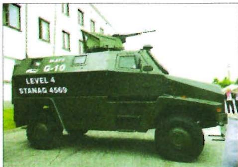
Высота машины 2,6 м, ширина 2,4 м, боевая масса от 12,5 до 14,5 т (в зависимости от комплектации). G10 рассчитана на перевозку 10 экипированных пехотинцев, включая экипаж (три человека).
